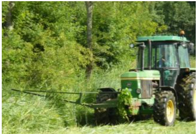
Barre d'effarouchement (Montreuil sur Loir)
